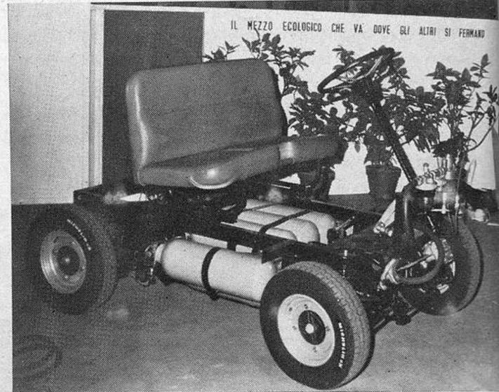
Autotelaio di vettura Sorgato, ad aria compressa
