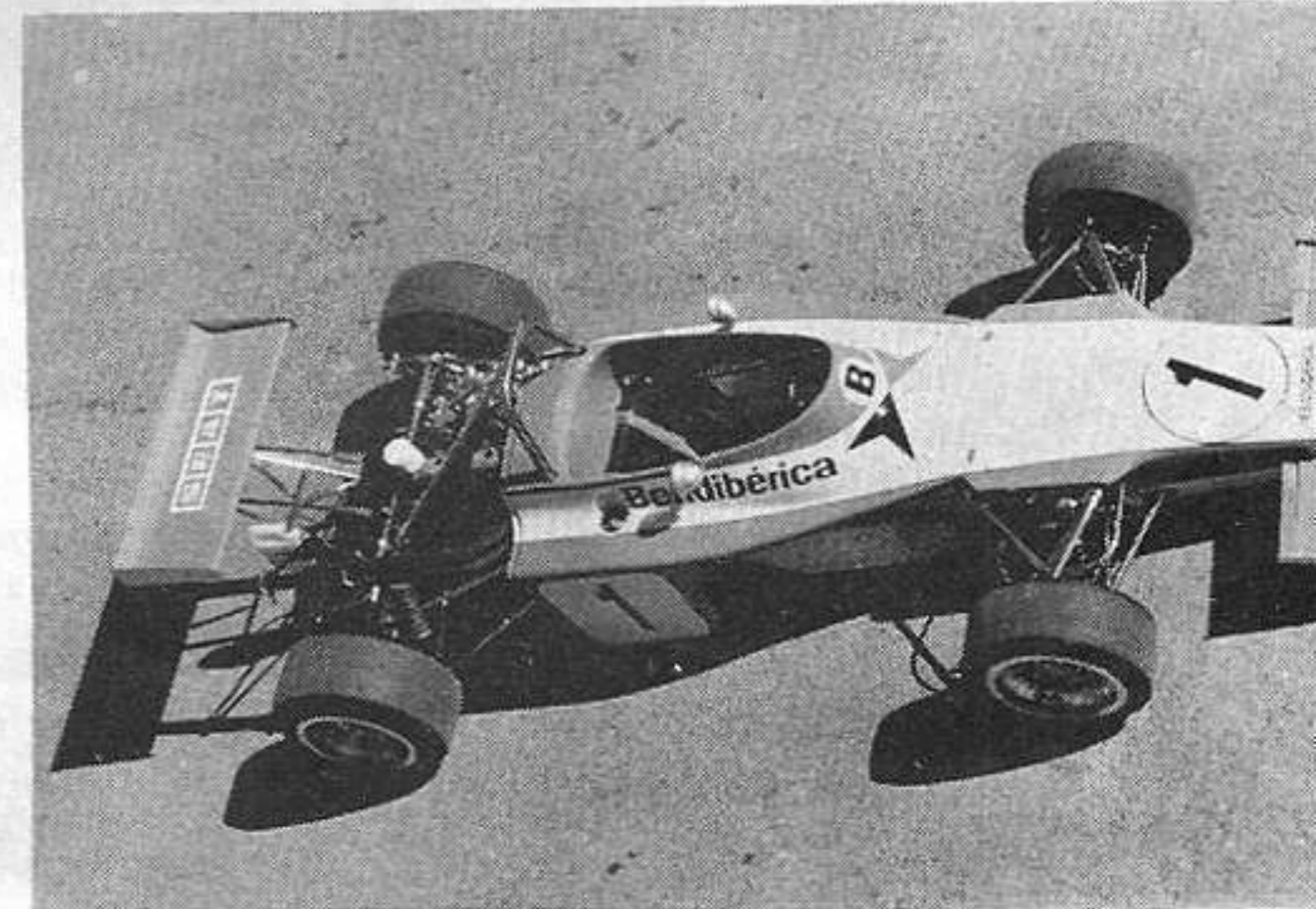
Il telaio scatolato e la bella linea che caratterizzano la nuovissima Selex ST-4 per la Formula 1800. La macchina monta per regolamento motore Seat bialbero a 4 carburatori e il cambio Hewland Mk6
