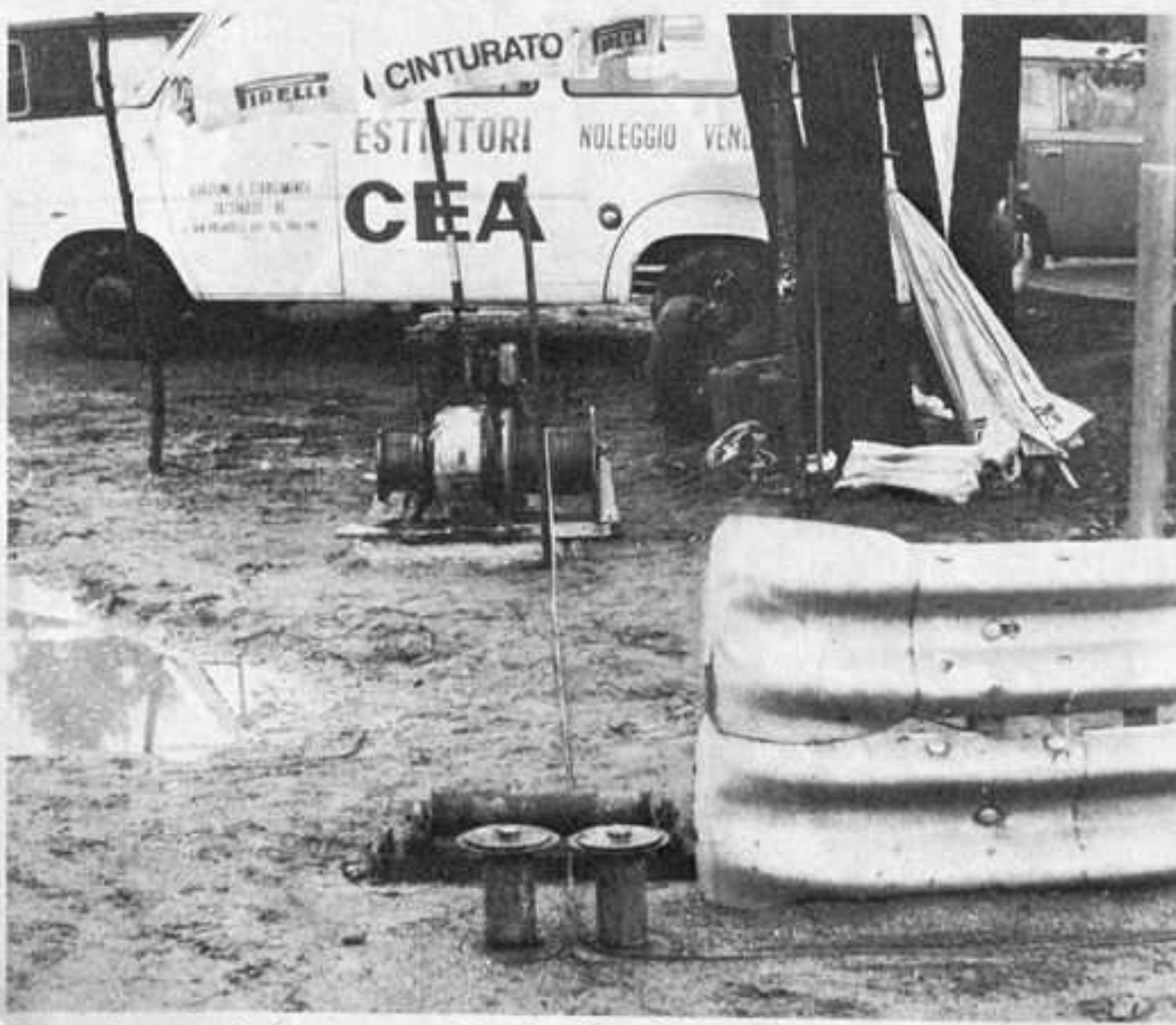
Dopo le nostre osservazioni, alla chicane di Monza è stato installato questo argano, con rinvii per l'uso in ogni senso
