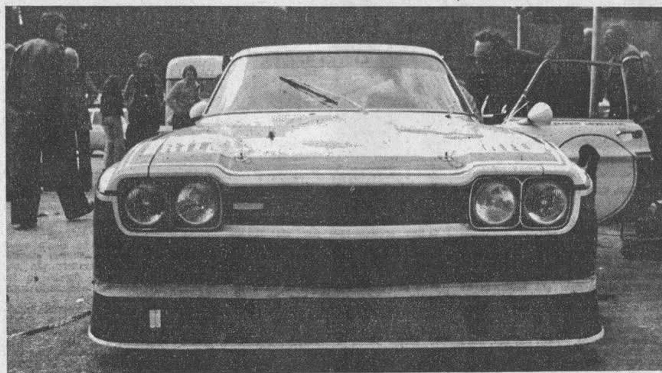
Poco fortunato l'esordio ufficiale delle Ford Capri con il nuovo motore Cosworth 24 valvole. Entrambe le vetture-Casa hanno rotto il motore. Da notare la nuova aerodinamica, con i radiatori in coda
