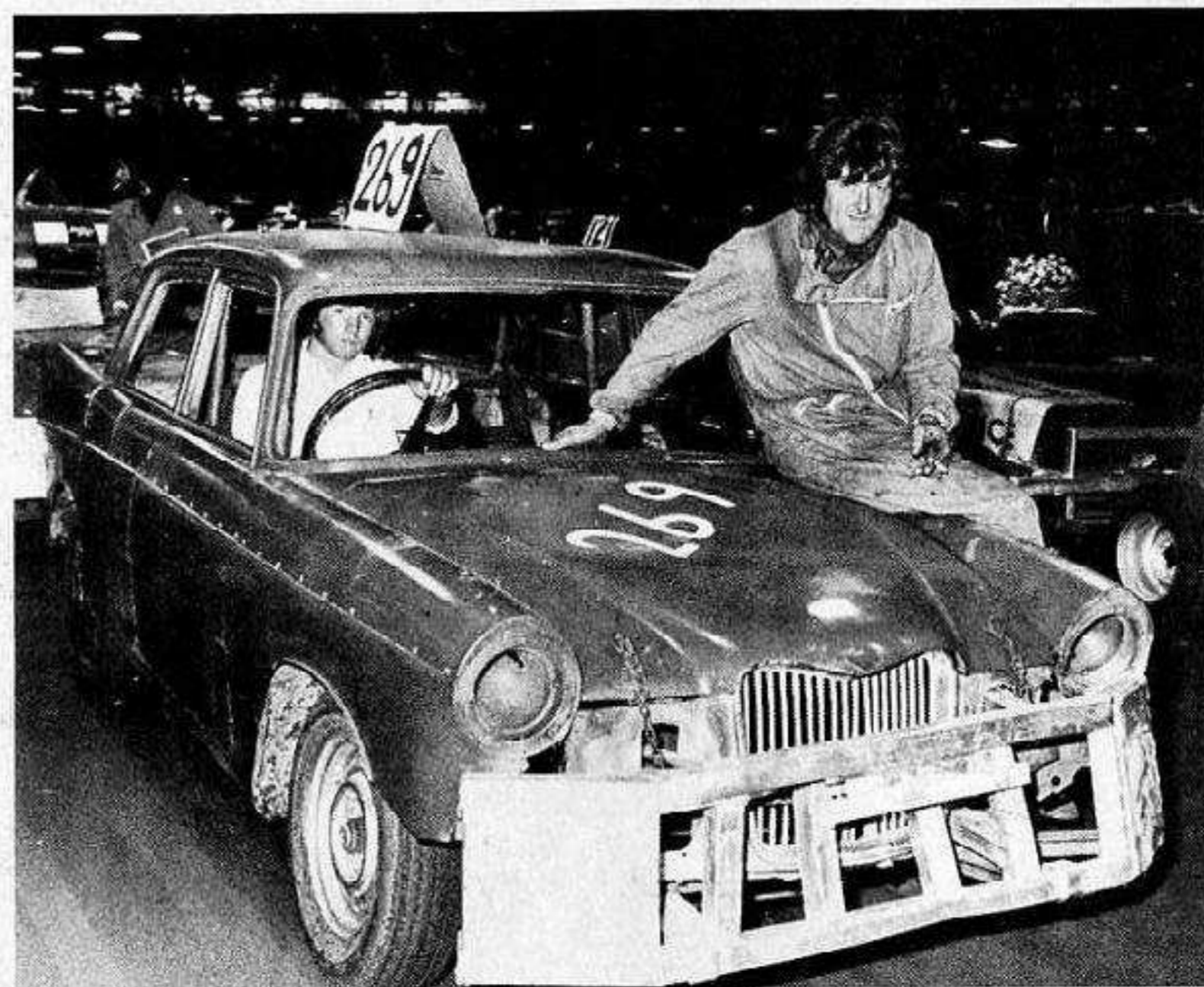
Il tipico Stock Car è una vettura trovata dal demolitore, irrobustita, dotata di paraurti e senza i vetri. Il tutto a circa 100.000 lire
